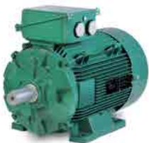
LS et LSES Non IE - IE2 - IE3 Aluminium IP55 Hauteur d'axe de 80 à 315 mm 2, 4 et 6 pôles IE2-IE3 : 0,75 à 200 kW Non IE : 0,12 à 45 kW
